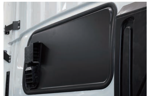
吸排気ダクト
