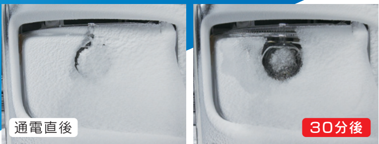
【試験条件】試験設備にて右記条件で検証実施 [ 温度 -5℃ / 風速 60km/h / 着雪量 120mm/hr ]
