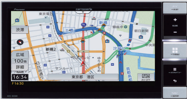
44 オンダッシュナビゲーションシステム (パイオニア) 詳細な渋滞情報や規制情報から精度の高い渋滞回避ルートを提案。 さらに、車両情報考慮ルート探索により、大型車の運行に重大な影響を与えかねない場所を回避したルートを探検。効率的な運行と事故の削減をサポートします。 *オンダッシュタイプ *サービスコネクター接続ハーネス8P（1-8671-4079-0）が必要です。 *車両のパーキングブレーキ信号を取り出すためには別途加工が必要になります。 *大型車に対応しているのはルート探索機能のみとなり、その他の機能は非対応となります。
