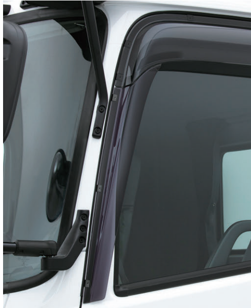
36 ドアピラーバイザーセット ●左右セット *装着にはドアバイザーセット（1-8671-1220-0）が必要です。
