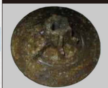
SPGガイド・ピストン：腐食大
