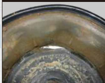
ダイヤフラム：劣化・亀裂
