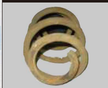
パワーSPG：泥付着・錆発生
