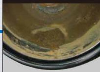
カバー内部：汚水侵入有り
