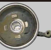
ベース：汚水侵入有り
