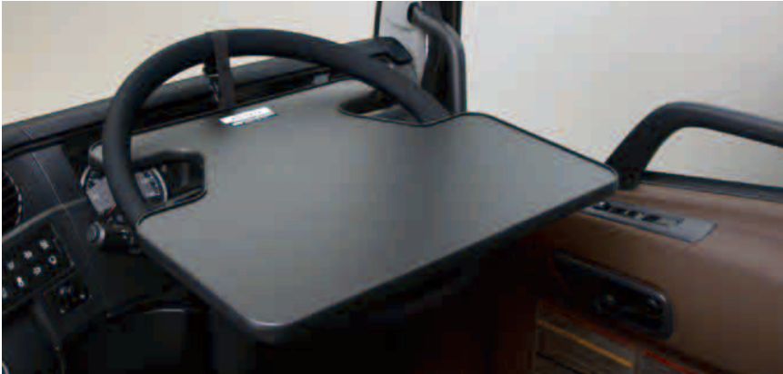
52 ステアリングテーブル 全面抗菌仕様 ※耐荷重：3.0kg ※ロゴステッカー2種（ISUZU/抗菌）付
