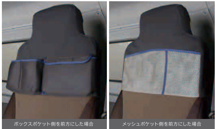
47 シートポケット ※耐荷重：各ポケット1.0kg 合計2.0kg ※助手席シートのみ対応。
