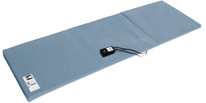
49 蓄熱式仮眠マット 一休さん（サービスコンセント付） 走行中に蓄熱が可能です。2時間以上の蓄熱で約7時間あたたかさを持続。 身体にフィットするゲル状蓄熱材を使用しています。 寸法：W510×L1950×H50mm ※「サービスコネクター接続ハーネス8P（1-8671-4079-0）」が必要です。
