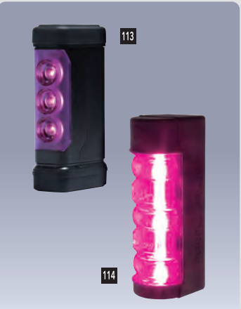
113 パープルセーバー 昼間約400m、夜間約1,000m以上の視認距離。停止表示番の代わりに使用可能なLED非常停止灯です。 寸法：約W32×H123×D63mm ※乾電池は別売です。(単4アルカリ乾電池4本)
